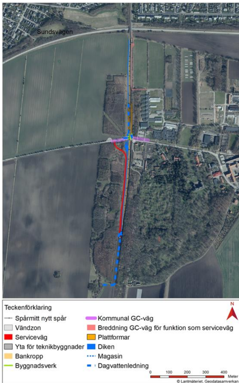
Figur 14. Placering av plattformar, teknikbyggnader och mötesspår (Sweco).
