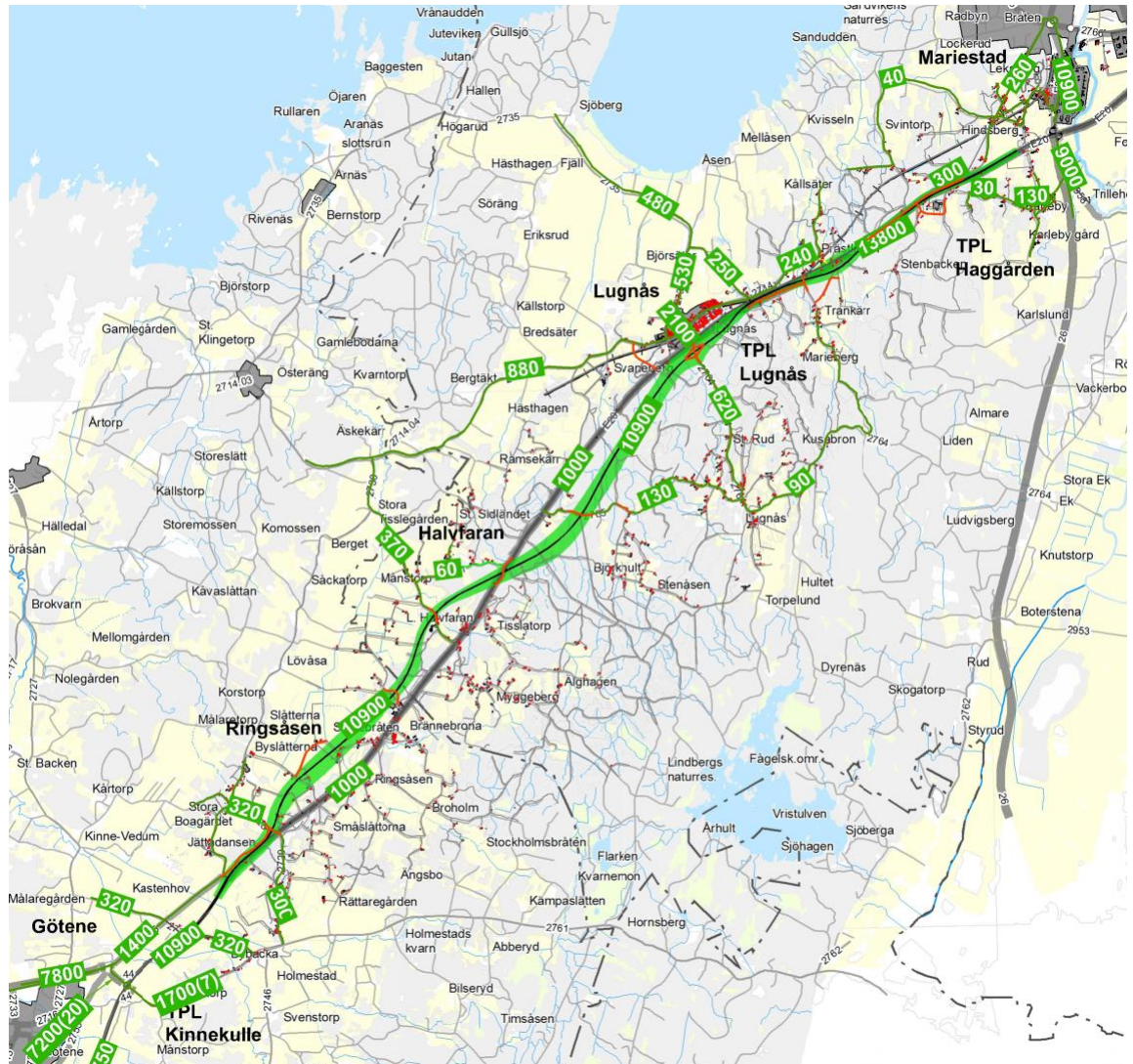
Figur 40: Trafikflöde (ÅDT) i grön korridor år 2045. Lokalvägnät syns i rött.
