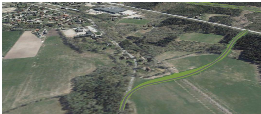
Figur 4.2.10.2 Bortvalt alternativ befintlig väg genom Lugnås till vänster och föreslagen ny väg med port under Kinnekullebanan till höger.
