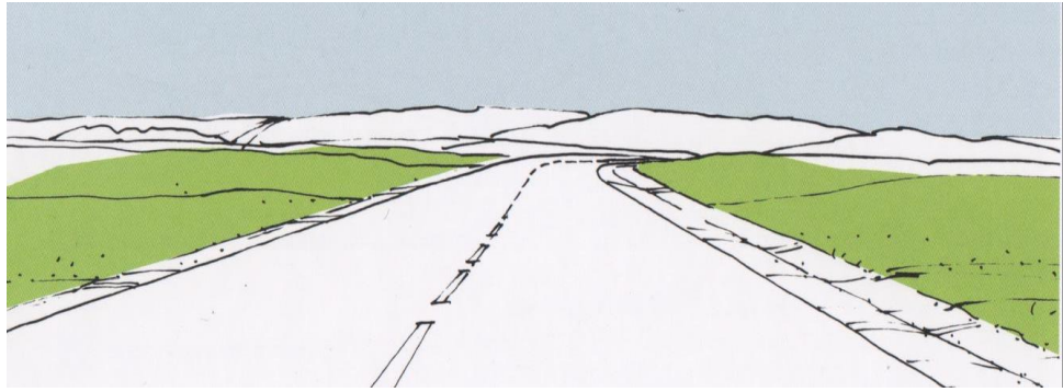
Bild 47. Exempel på möjlig behandling av slänter i jordbruksmark där slänterna utformas så att de blir bruksbara för traktorer. Illustration: Vägen. En bok om vägarkitektur.
