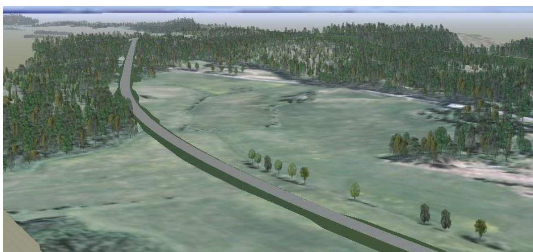
Bild 41. Alternativ 2 från ovan sedd söderifrån mot nordost. För att vägen inte ska ligga i lågpunkten i dalen och för att få en bra linjeföring behöver den troligen läggas så långt västerut i korridoren som möjligt.
