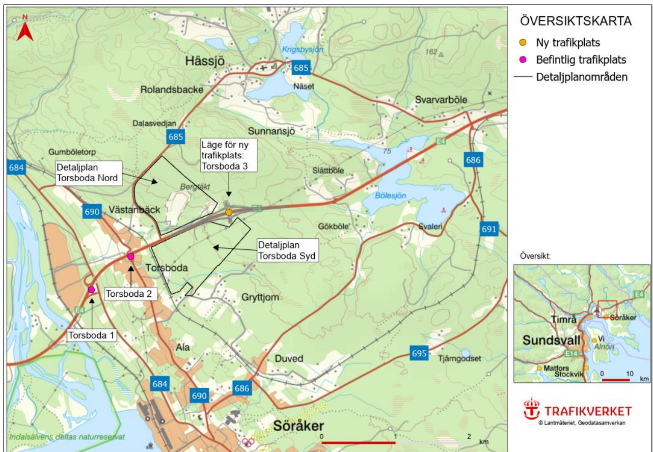
Figur 1. Den planerade trafikplatsens utbredning visas i grått och broplaceringen med gul prick. Väg 685 som kallas för Hässjövägen har anslutningar mot E4 i Torsboda och Svarvarböle.
