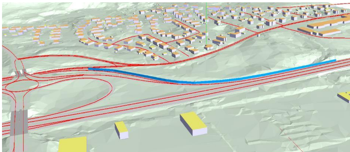
Figur 9. Visar avfärdade bullerskyddsskärmen längs avfarten mot trafikplats Råslätt.
