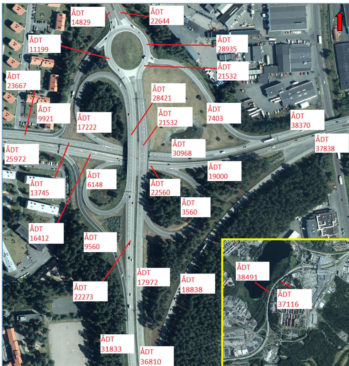
Figur 26. Prognosticerad årsmedeldygnstrafik (Ådt) år 2050 (20 år efter öppnande) på aktuellt vägnät i anslutning till trafikplats Ljungarum, © Eniro.
