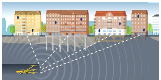
Vibrationer och stömljud fortplantar sig genom berget och upp i husen. Hur mycket beror på bergets kvalitet och husens grundläggning.
