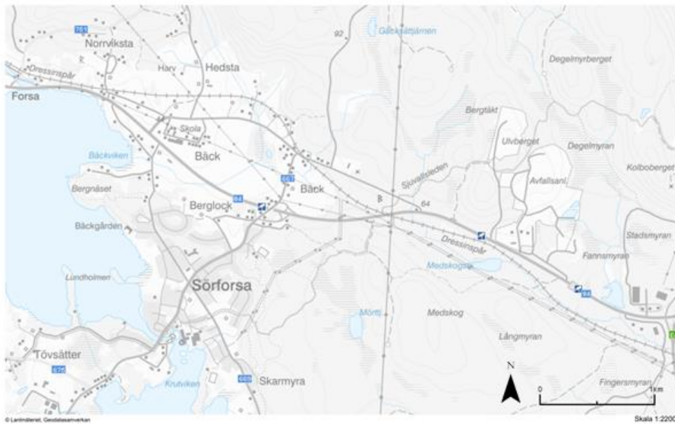
Figur 4.8 - Kartutdrag från NVDB som visar placering av trafiksäkerhetskamerorna (ATK) samt förekommande luftledningar. Källa: www.trafikverket.se.
