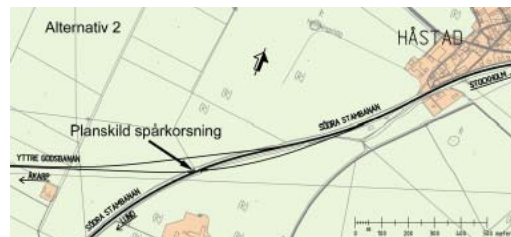
Figur 87. Utformningsskiss för planskild anslutning till Södra stambanan vid Håstad
