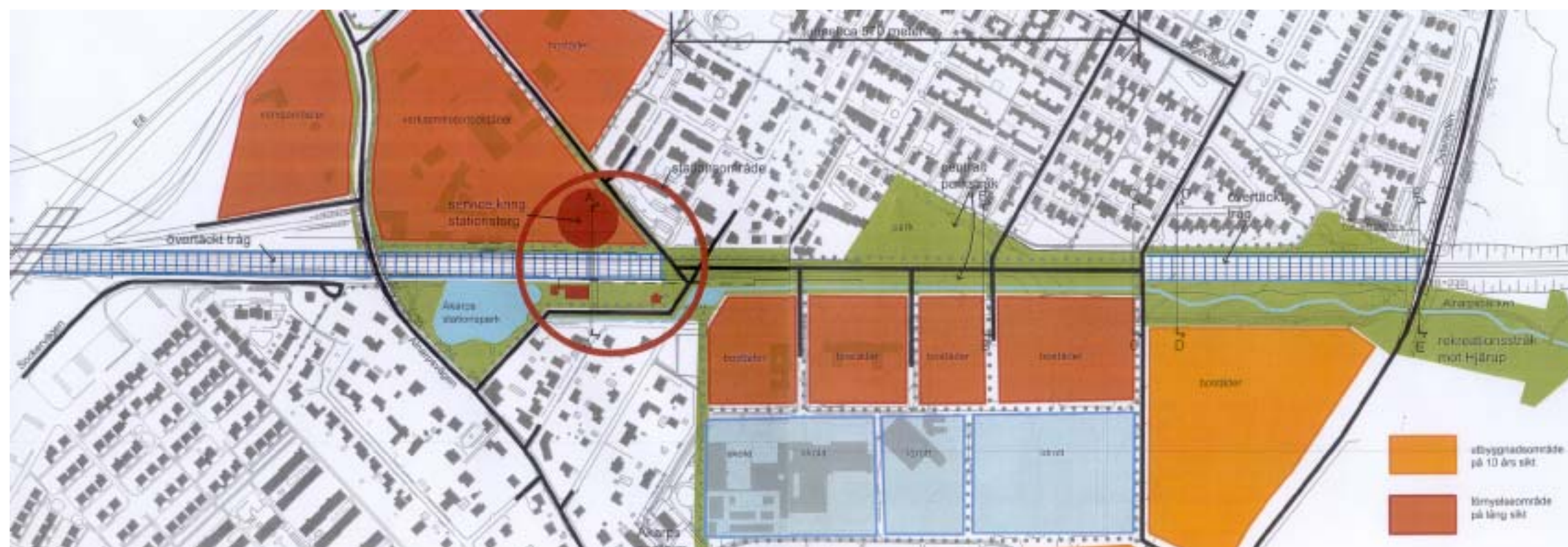
Figur 73. Planskiss med kort tunnel och överdäckade rampsträckor (FFNS 2003).
