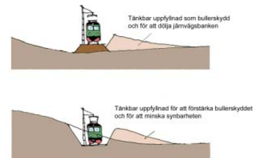
Figur 30. Med järnvägen i skärning och med flacka kompletterande vallar minskar synbarheten
