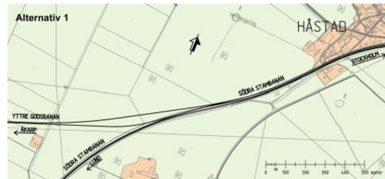
Figur 36. Förkastat alternativ med anslutning av Yttre godsbanan i plan till Södra stambanan vid Håstad
