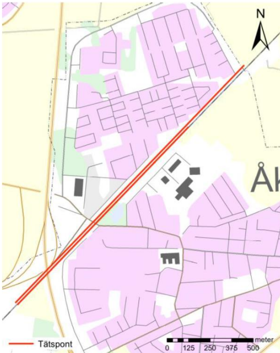
Figur 6.9 Placering av tätspont i byggskedet.
