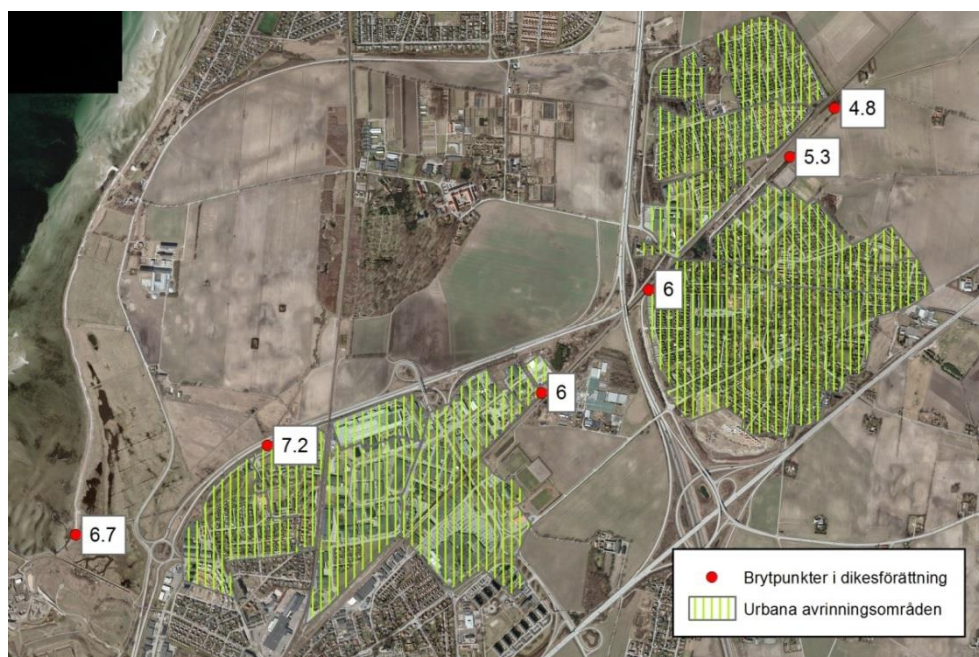
Figur 2.6 Grönrandiga områden markerar avrinningsområden som bidrar med dagvatten via ledningsnät. Röda punkter anger dimensionerande vattenföring i m^3/s enligt gällande dikesförrättning. Differensen mellan två på varandra följande punkter utgör det acceptabla tillskottet av vatten längs sträckan.
