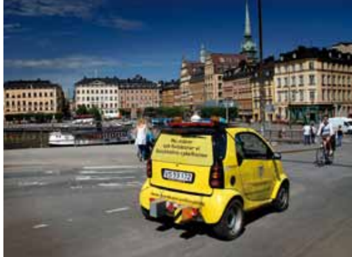
Mätning av cykelvägars längsgående jämnhet i två spår. Exempel från Stockholm.
