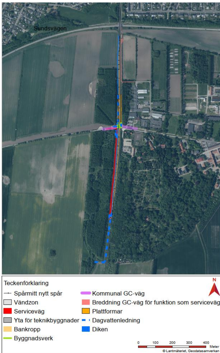
Figur 2. Område för föreliggande jämvägsplan, placering av nya plattformar, teknikbyggnader och mötesspår (Sweco).
