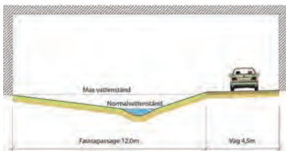
3.2:4 Principutformning av faunapassage, sektion
