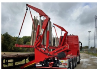
Figur 22 Överlyftning av containerflak mellan vägfordon och järnvägsvagn (Hammar Maskin)
