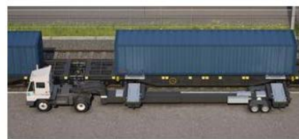
Figur 26 Animerad bild av överföring av container mellan järnvägsvagn och terminalfordon (Innovatrain)
