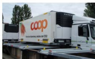
Figur 25 Direkt överföring av växelflak klass C mellan vägfordon och järnvägsvagn (Innovatrain)
