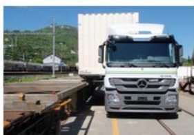
Figur 25 Direkt överföring av växelflak klass C mellan vägfordon och järnvägsvagn (Innovatrain)
