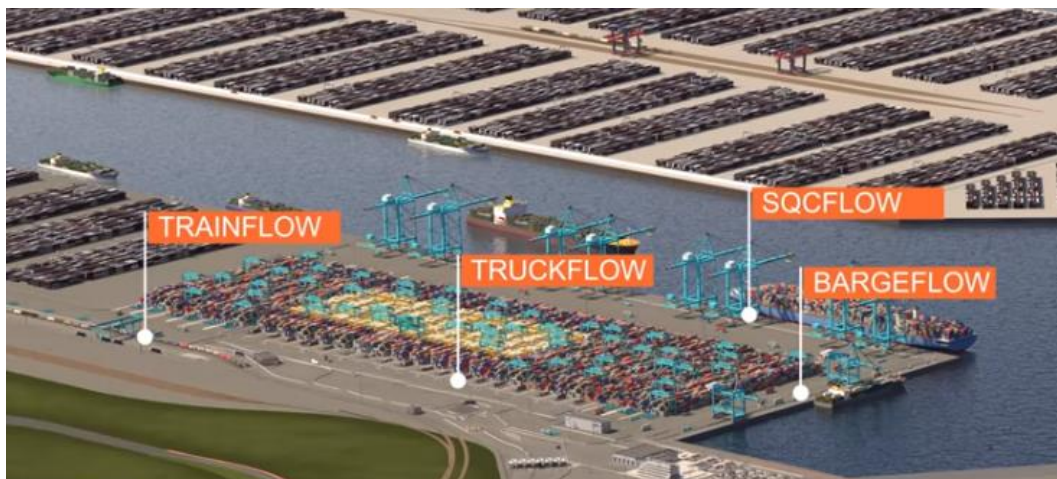
Figur 12 Containerterminal med kaj för pråmfartyg. Källa: https://www.apmterminals.com/en/maasvlakte/services/barge-handling
