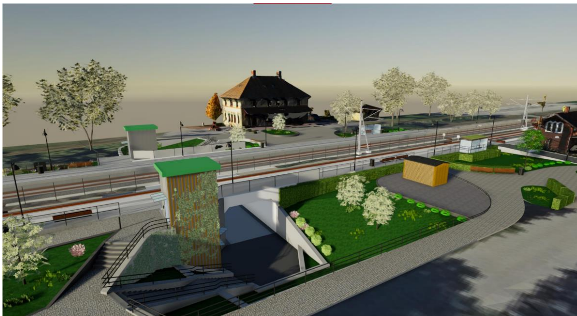
Illustration av utredningsalternativet med ny planskild passage med tillhörande trappor, hissar och planteringar samt ny plattform och nytt mötesspår.
