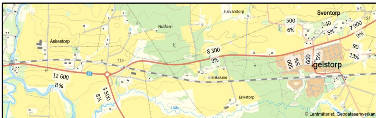
Figur 4. Trafikmängd nuläge; Totalt antal fordon/dygn, resp. andel tung trafik (%). Utdrag ur © Lantmäteriet, Geodatasamverkan.
