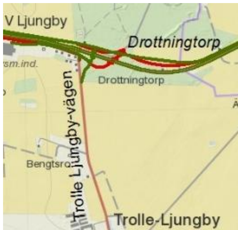
Figur 40 Röda linjer avser bortvald lösning för placering av planskildhet och sträckning av lokalvägnätet.
