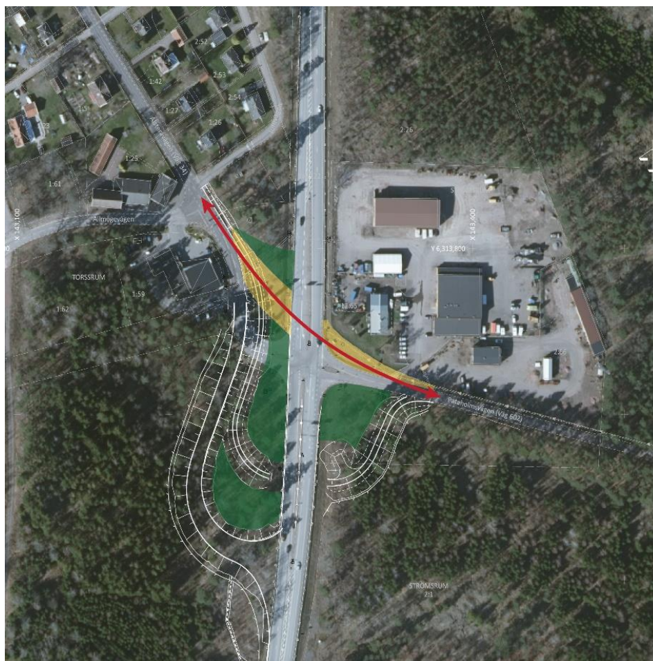
Figur 16. Planskiss över förslag till gestaltungsprinciper för förtydligande av siktlinje längs kulturhistoriskt värdefulla vägars tidigare sträckning. Gula ytor avser yta med äng eller långgräs. Gröna ytor avser ytor för plantering av skog bestående av ek och tall. Röd pil avser önskad siktlinje. Observera att ytornas utbredning är schematisk, exakt placering av träd ska anpassas utifrån trafiksäkerhetsaspekter under projektering.
