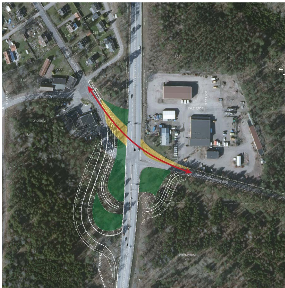
Figur 10. Planskiss över förslag till gestaltungsprinciper för förtydligande av siktlinje längs kulturhistoriskt värdefulla vägars tidigare sträckning. Gula ytor avser yta med äng eller långgräs. Gröna ytor avser ytor för plantering av skog bestående av ek och tall. Röd pil avser önskad siktlinje. Observera att ytornas utbredning är schematisk, exakt placering av träd ska anpassas utifrån trafiksäkerhetsaspekter under projektering.
