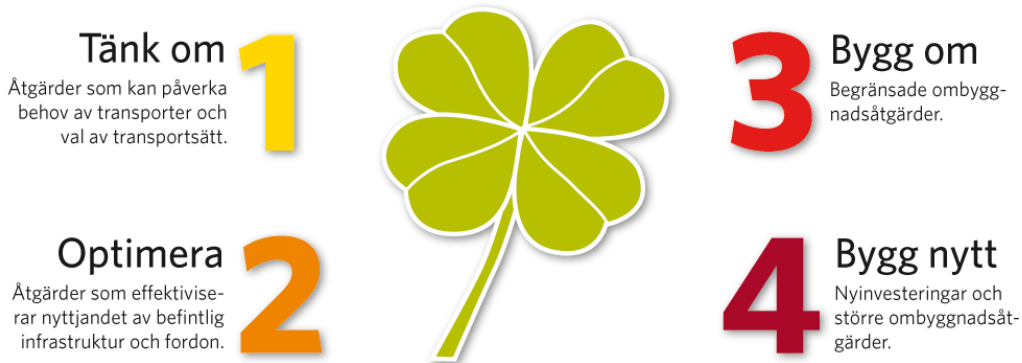
Figur 4. Fyrstegsprincipen, Trafikverkets principiella analysmetod för infrastrukturprojekt.
