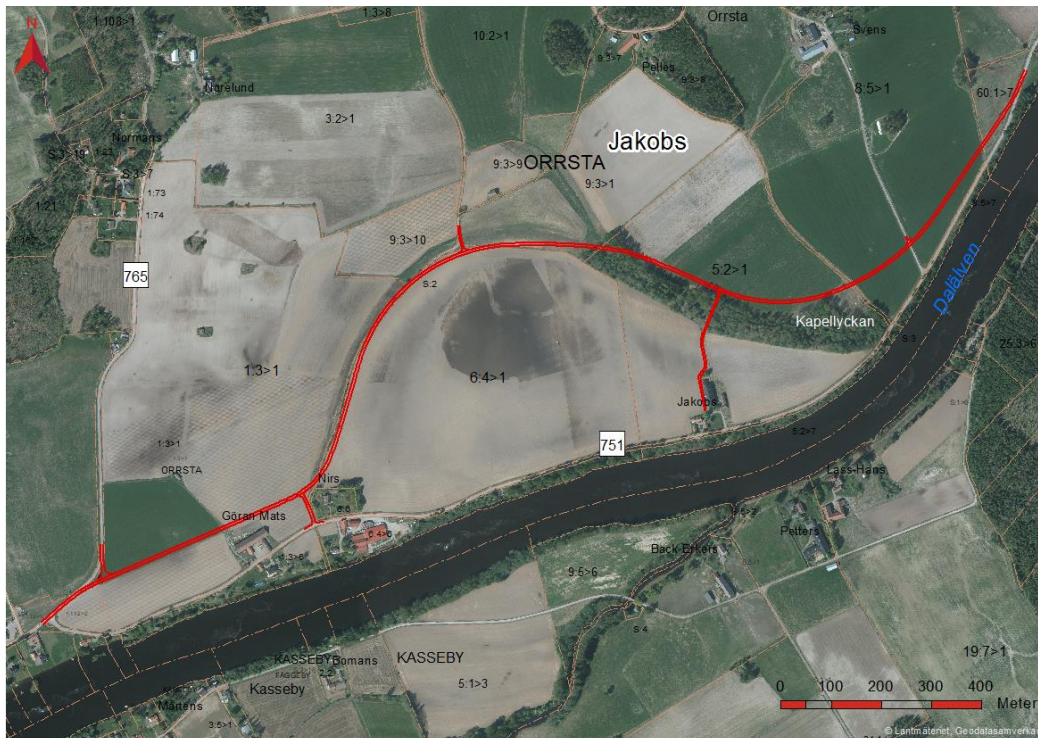
Figur 9. Föreslagen vägutformning för väg 751 i Jakobs med preliminära anslutningsvägar till bostäder.
