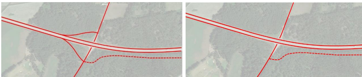
Figur 34. Studerade alternativa utformningar av Björketorps korsningen, förordat alternativ till vänster i figuren. Befintlig E22 och nord-sydgående väg heldragen röd linje. Planerad lokalväg röd streckad linje. Föreslagna ramper i vänstra bilden, röd heldragen linje.
