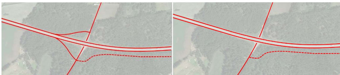
Figur 10. Studerade alternativa utformningar av Björketorpskorsningen, förordat alternativ till vänster i figuren. Befintlig E22 och nord-sydgående väg heldragen röd linje. Planerad lokalväg röd streckad linje. Föreslagna ramper i vänstra bilden, röd heldragen linje.
