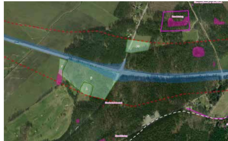
Figur 20. Landskaps- och kulturarvsanalysen: Landskapet kring Björketorpskorsningen domineras av barrskog. Blått i kartbilden marker planerat område för breddning av väg samt anläggande av rampar och lokalväg. Mörkrosa markerar registrerade forn- och kulturlämningar och grönt markerar utredningsobjekt. Streckad vit linje markerar den gamla kustlandsvägen.
