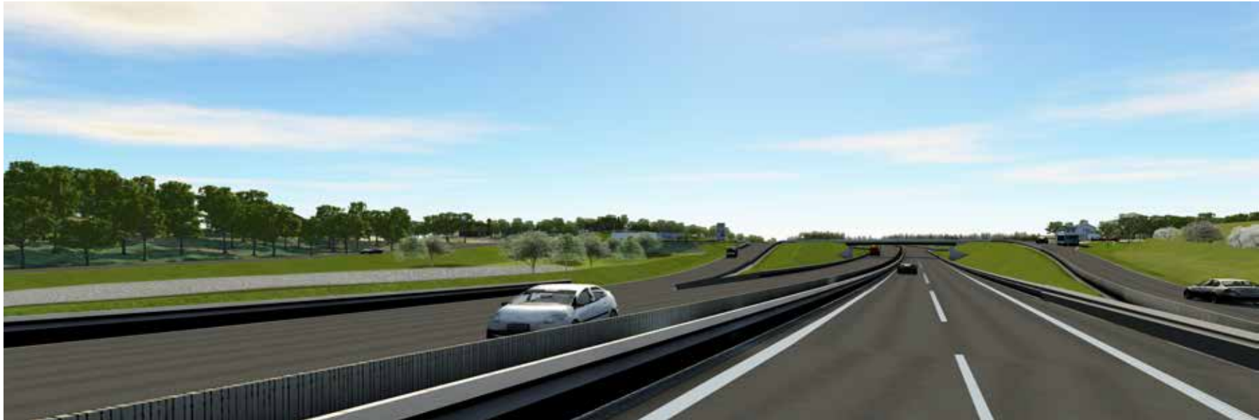
Figur 32. Perspektiv från öst mot trafikplats. Till vänster skymtar den nya lokalvägen bakom de nya dagvattenmagasinen. I höjd med den nya bron skymtar macken till vänster och Bistro Blå till höger. Av- och påfarter leder upp mot bron. Till höger om avfarten antyds blommande buskträd på den nya bullervallen.
