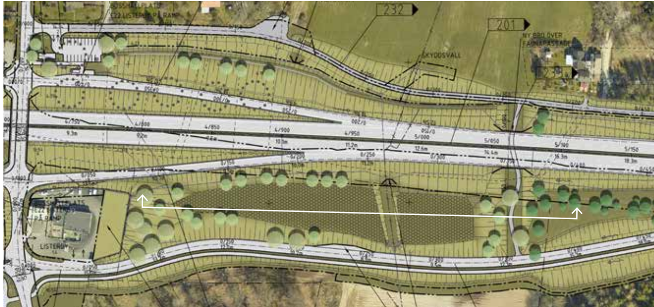
Figur 28. Illustration av Listerby trafikplats, öster om bron: Dagvattendammar och faunapassage. Öster om bron förläggs ny E22 norr om befintlig väg. Lokalväg och cykelväg går i kanten av befintlig ekdunge och leds österut mot Förkärla i samma läge som befintlig väg. Ersättningsvägar, av- och påfarter till den nya bron, lokalväg och ny motorväg har anpassats till landskapet men har ändå medfört att fler hus behöver rivas. En hög bullervall och dagvattenmagasinen blir nya inslag i landskapet. Nya träd har illustrerats vid pendlarparkeringar, dammar och faunapassage samt där befintlig E22 rivs och återställs med skog. (Prickad cirkel representerar fastighet som löses in) Sektion enligt figur 29.
