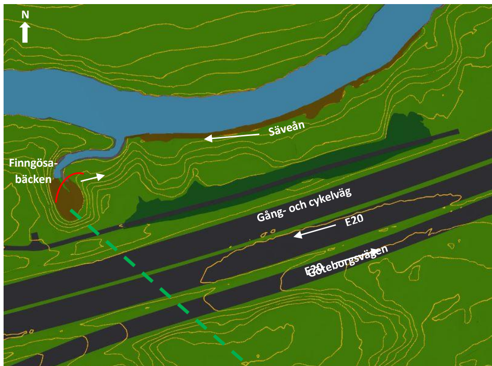
Figur 24. Översikt över planerade åtgärder; stödfyllning/erosionsskydd (bruna områden), avschaktning (mörkgrönt område vid gång- och cykelväg), ny trumma (grön streckad linje) och erosionsskydd i Finngösaravinen (röd linje).
