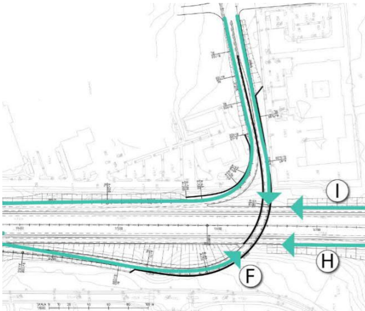
Figur 42. Vattnets avrinningsriktning längs med vägområdet, beräkningspunkt F/H/I.
