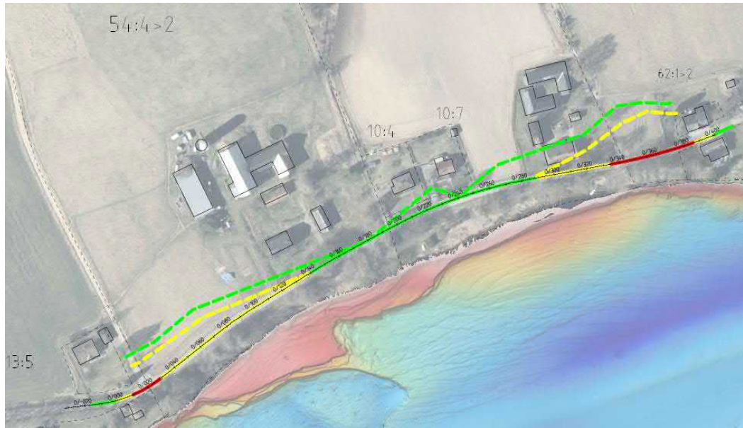
Figur 12. Den södra linjen visar befintlig stabilitet. Färgförklaring: Grön = bra, Gul = OK och Röd = Väldigt dålig. De norra sträckande linjerna visar var vägens läge skulle få en ok eller bra stabilitet.
