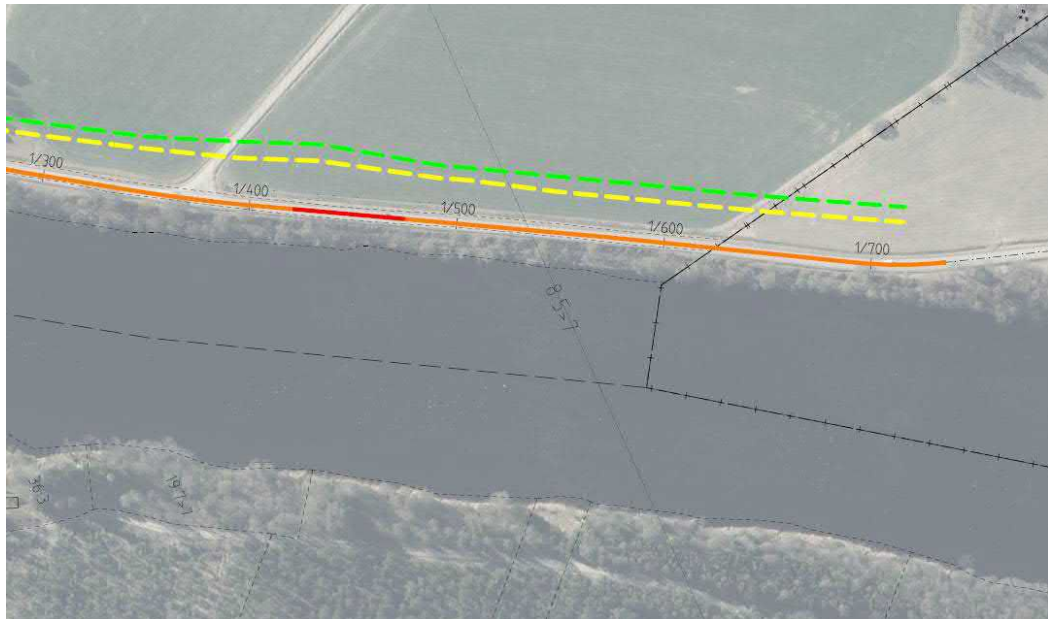
Figur 14. Kilometertal 1/300-1/700. Den södra linjen visar befintlig stabilitet. Färgförklaring: Grön = bra, Gul = OK, Orange = Dålig och Röd = Världigt dålig. De norra sträckande linjerna visar var vägens läge skulle få en ökning eller bra stabilitet.
