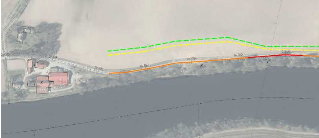
Figur 12. Kilometertal, med början i väster i Jakobs, 0/200-0/600. Den södra linjen visar befintlig stabilitet. Färgförklaring: Grön = bra, Gul = OK, Orange = Dålig och Röd = Väldigt dålig. De norra sträckande linjerna visar var vägens läge skulle få en ok eller bra stabilitet.
