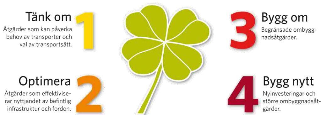
Figur 4. Fyrstegsprincipen, Trafikverkets principiella analysmetod för infrastrukturprojekt.
