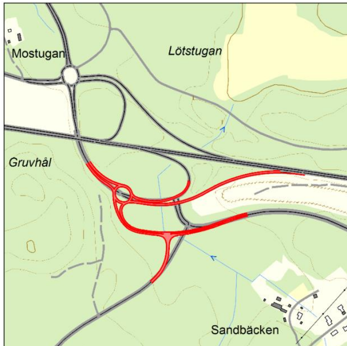
Figur 3. Förslag på korsningsåtgärd för södra rampsystemet genom en ny cirkulationsplats (röd färg). Norra delen av utredningsområdet för vägplanen (Trafikverket, 2017).
