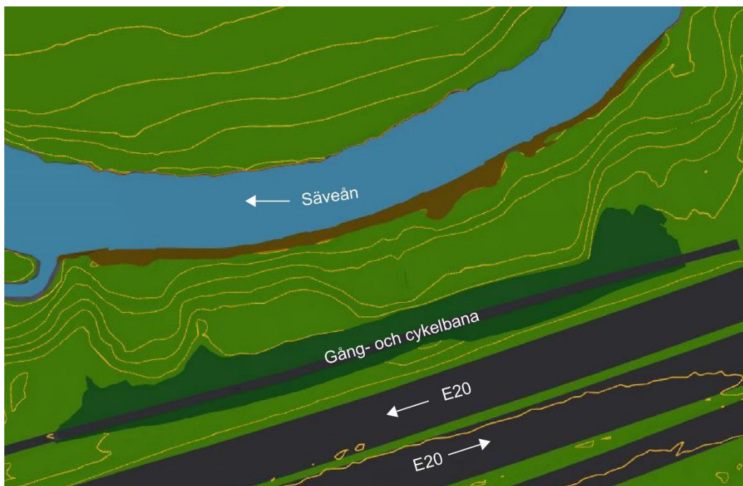
Figur 11 Schematisk utbredning för erforderliga åtgärder i form av avschaktning (märkgrön) och stödfyllning/erosionsskydd (brun), vid medelvattenstånd. 18
