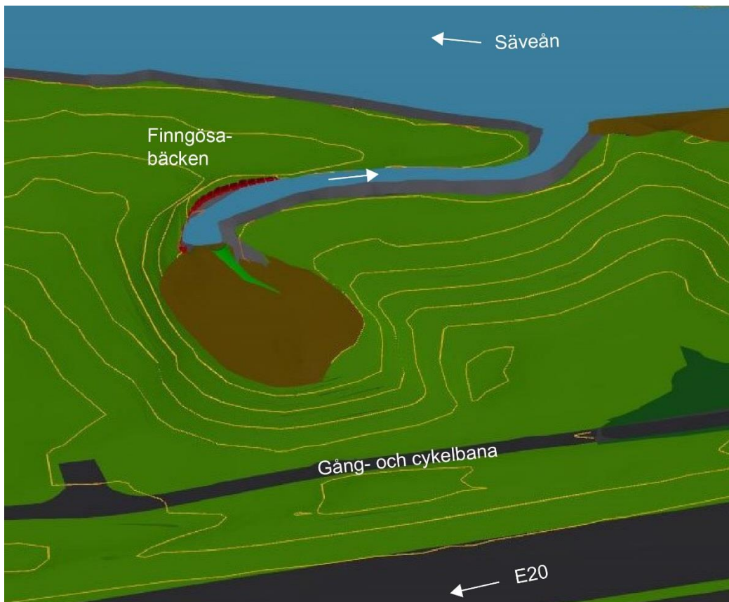
Figur 13 Schematisk utbredning för erforderliga stabilitetsförbättrande åtgärder i form av stödfyllning (brun) i Finngösaravinen, vid medelvattenstånd. I figuren syns även planerad ny trumma (klargrön) samt erosionsskydd (rött). Observera att illustrationen är en perspektivbild tagen snett uppifrån.
