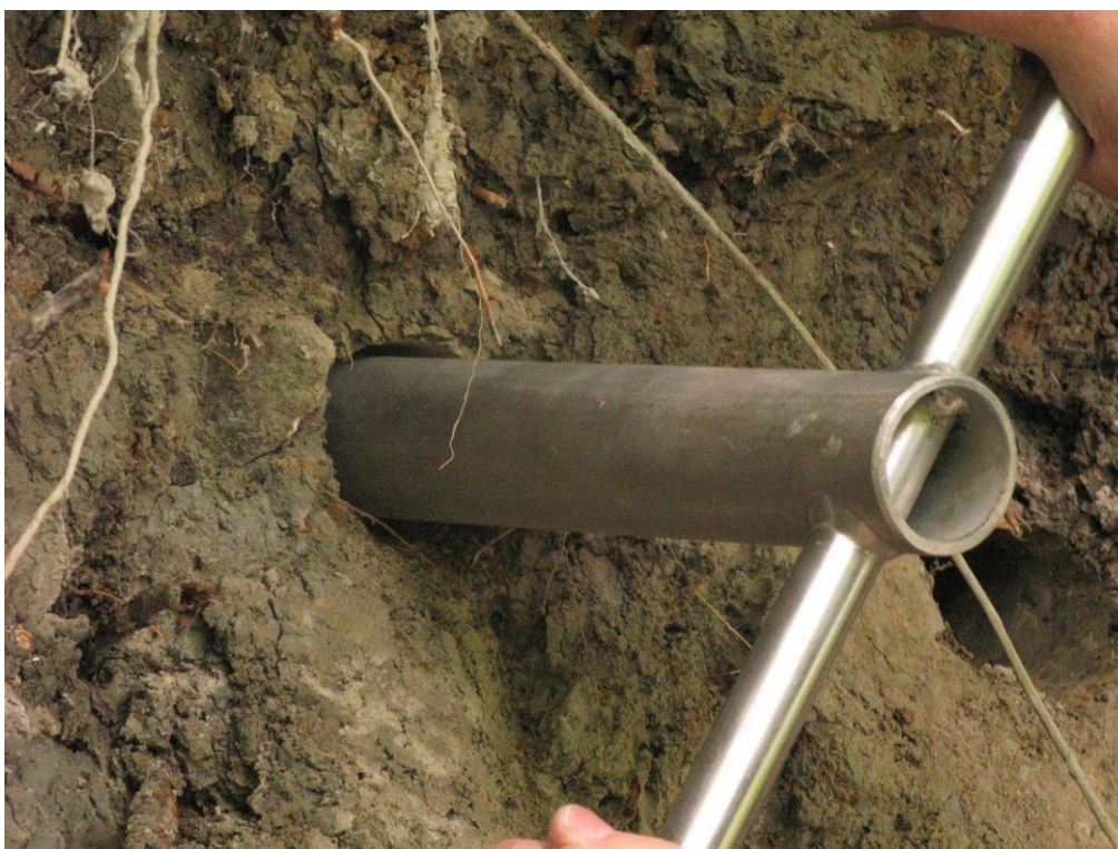
Fig 4. "Förborrning av bohål i täta jordartsmaterial med hjälp av specialborr. Foto K. Ström
