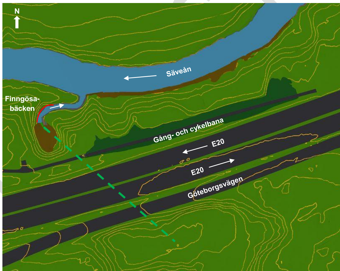
Figur 30. Översikt över planerade åtgärder; stödfyllning/erosionsskydd (bruna områden), avschaktning (mörkgrönt område vid gång- och cykelbana), ny trumma (grön streckad linje) och erosionsskydd i Finngösaravinen (röd linje).
