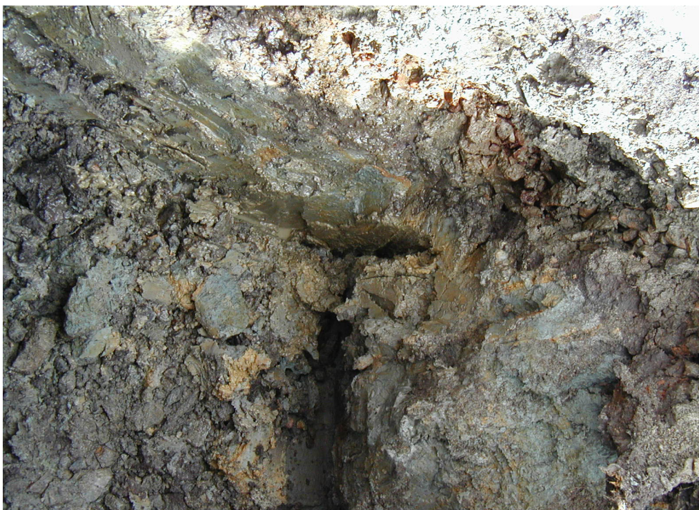
Lös lera med inläckage av vatten i Provgrop B.
