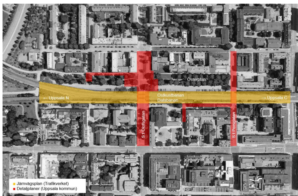
Figur 1. Översiktskarta över järnvägens korsning med S:t Persgatan och S:t Olofsgatan i centrala Uppsala. Den gula markeringen visar aktuell sträcka av järnvägsanläggningen. De röda markeringarna visar aktuella sträckor av S:t Persgatan och S:t Olofsgatan som byggs om i samband med den kommunala planeringen.
