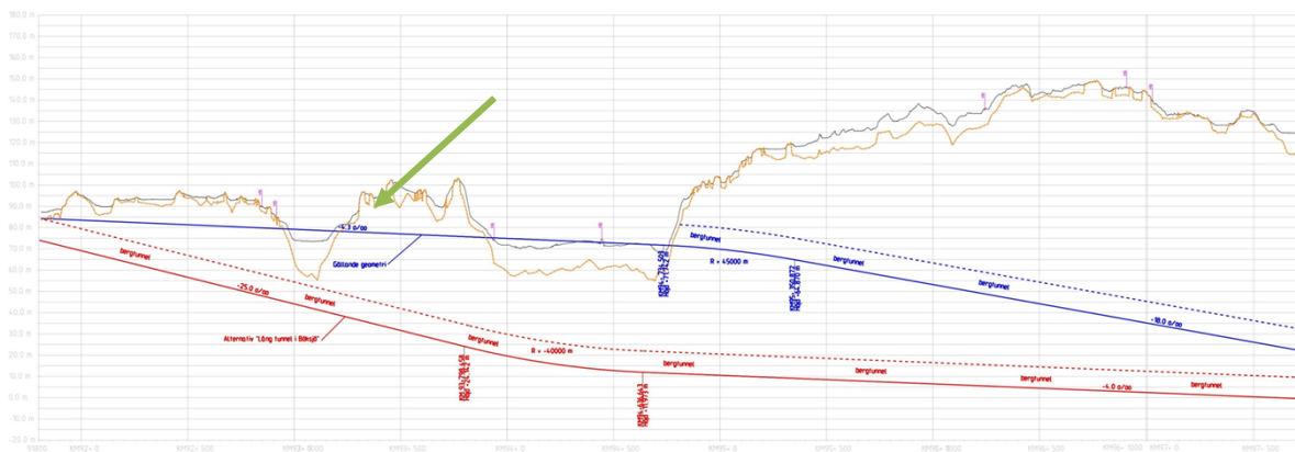
Figur 19. Blå streck visar spårprofilen för alternativ 17 och röda streck visar spårprofil för alternativet med förlängd tunnel till länsgränsen. Grön pil visar ungefär var tunneln skulle gå upp till ytan för ett mellanalternativ (som inte redovisas i bild).
