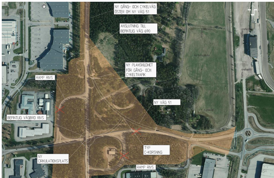
Figur 22. Illustrationsplan med utformningsalternativ som går genom täktområdet. Med detta alternativ uppfylls funktionskrav för 80 km/h. Den identifierade utredningskorridoren är markerad med orange ton.
