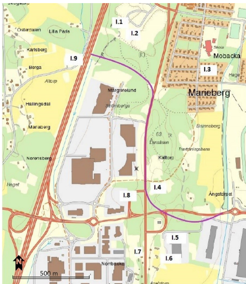
Figur 26. Potentiellt förorenade objekt i förhållande till vägförslaget (Länsstyrelsens MIFO-databas).
