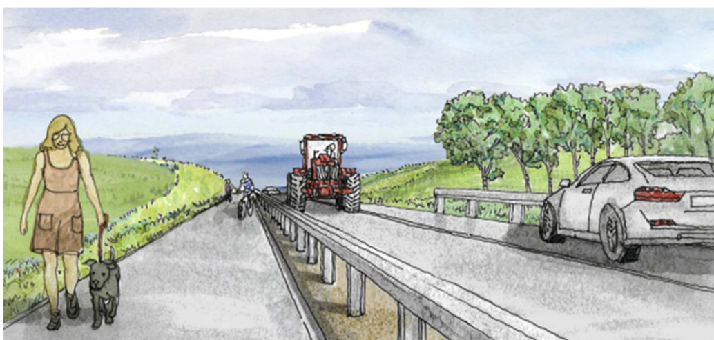
Figur 15 Skiss av utformning där avgränsning sker med räcke. Bild ÅF.
