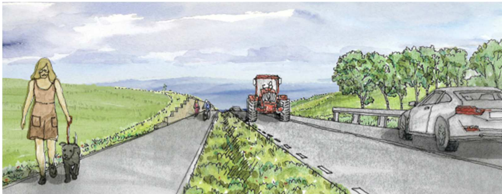
Figur 21 Skiss av utformning med stödmur mot åsen vid höjdpunkten. Bild ÅF.
