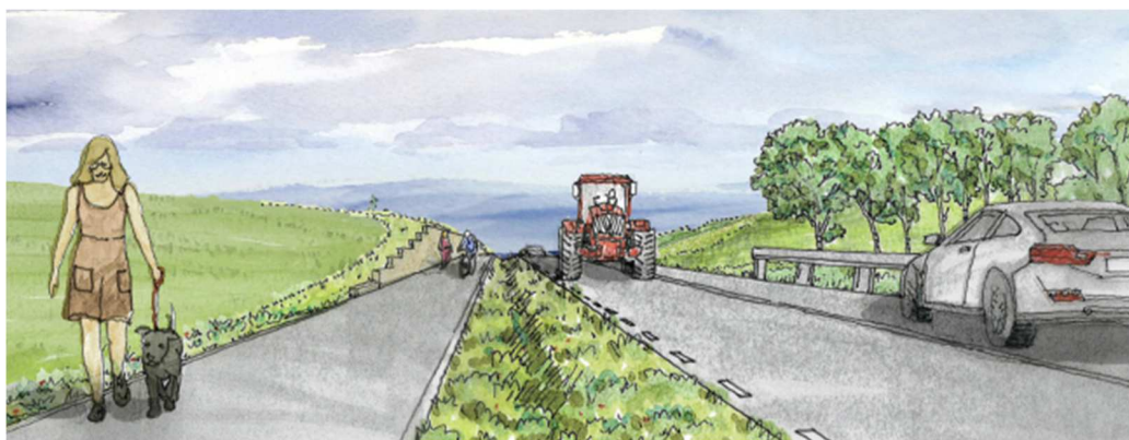
Figur 22 Skiss av utformning med stödmur mot åsen vid höjdpunkten. Bild ÅF.
