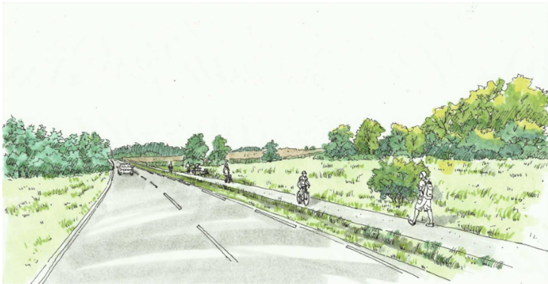
Figur 6 Typsektion med skiljeremsa. Idéskiss ÅF.
