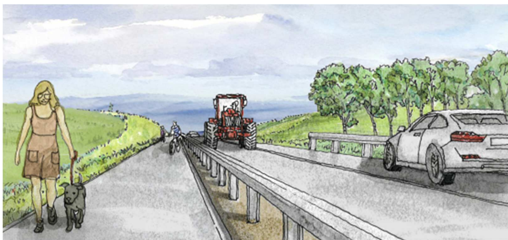
Figur 15 Skiss av utformning där avgränsning sker med räcke vid höjden. Bild ÅF.
