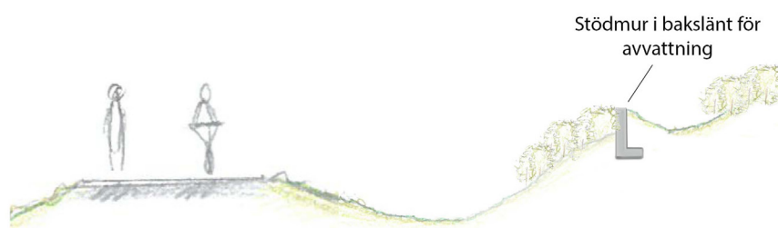
Bild 27. Illustration över gc-vägen och stödmuren i bakslänt. Illustration av Karin Johansson och Hanna Lange
