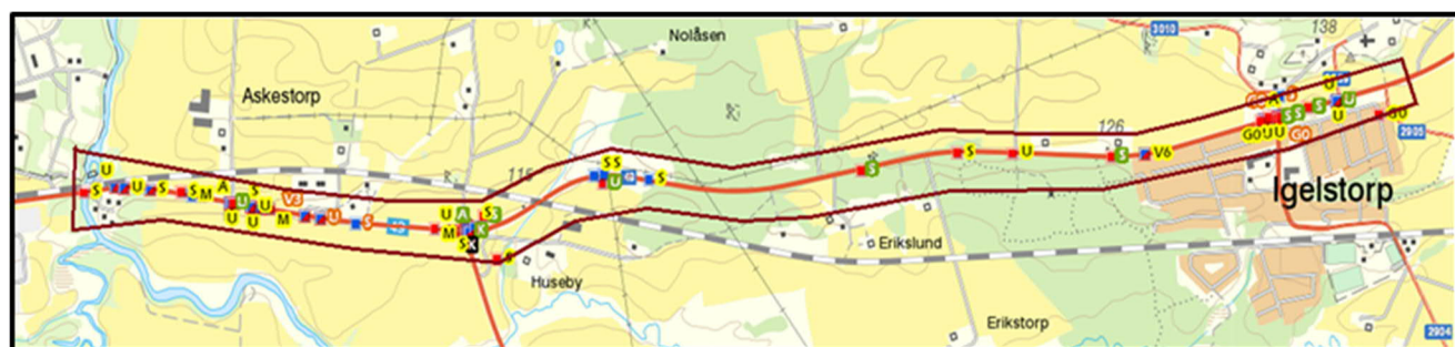
Figur 7. Trafikolyckor på aktuell vägsträckning (S=singel-motorfordon, U=upphinnandeolycka, A=avsvängande motorfordon, K=korsande motorfordon, M=mötesolycka, G0=fotgängare singel, V3=traktor etcetera, V6=backning, vändning). Färgen visar skadegrad: Grön=ingen personskada, Gul = lindrig olycka, Orange = Måttlig olycka, Röd = allvarlig olycka, Svart= dödsolycka. Utdrag ur © Lantmäteriet, Geodatasamverkan.
