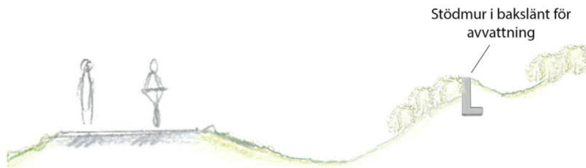
Figur 43. Illustration över gång- och cykelvägen och stödmuren i bakslänt. Illustration av Karin Johansson och Hanna Lange.
