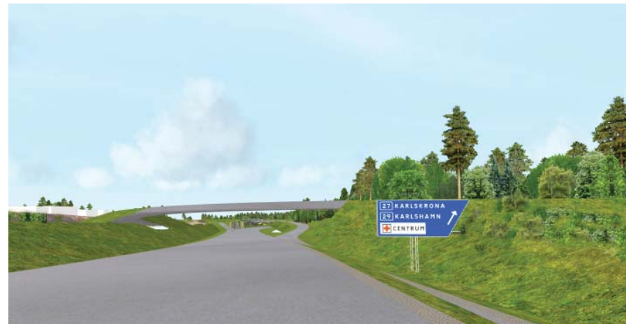
Figur 56. Bild ur vägmodell som visar skyltarna utmed väg 25 i riktning mot Växjö. Bron över vägen skymms inte av dessa.
