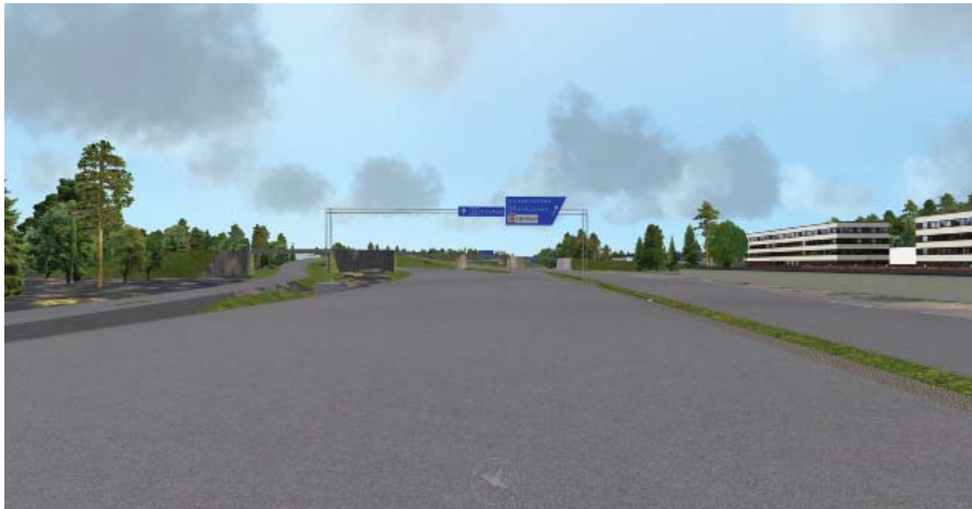
Figur 38. Portalen med tavlor som anger avfarter mot Karlskrona och Kalmar (Väg 27), samt väg 25 och centrum. Vyn ur vägmodellen visar att tavlorna ej skymmer GC-porten över Österleden längre söderut.
