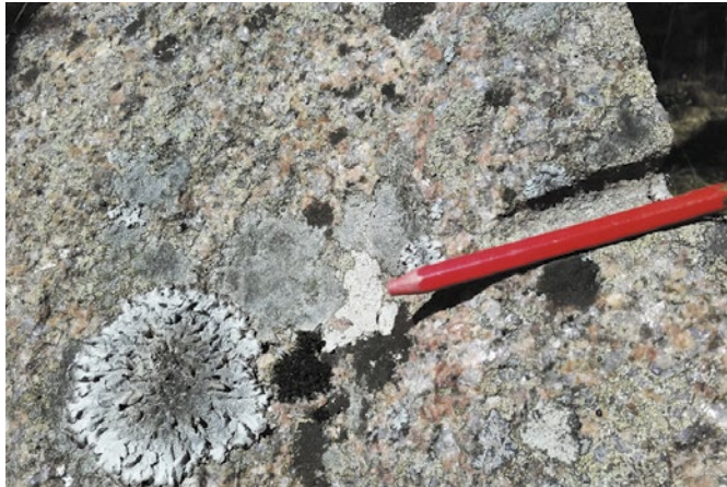
Figur 5. Block av medelkornig granit sannolikt brutet ur ett större block. Pennan ligger i ett kilhål.
