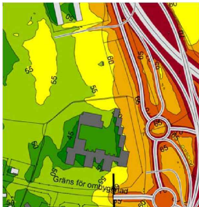
Figur 49: Framtida buller i vägförslaget. Fagrabäcksvägen ingår ej i vägplanen och buller därifrån har därmed inte beräknats.
